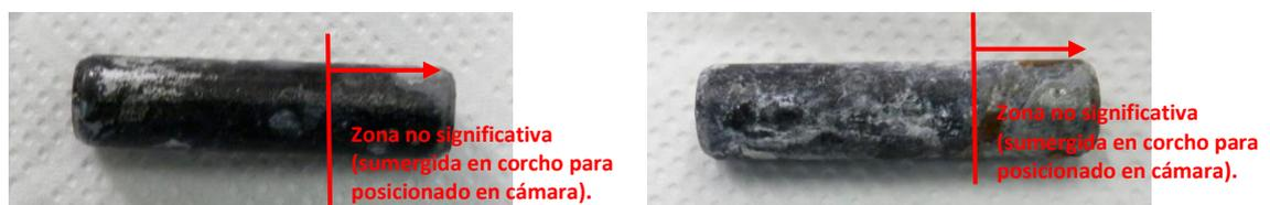
Muestra 2 tras 48 y 96 horas de ensayo (de izqda. a dcha.)
