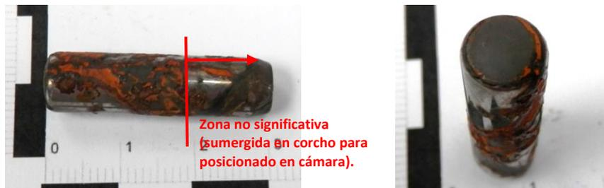
Muestra 1 tras 48 horas de ensayo.
